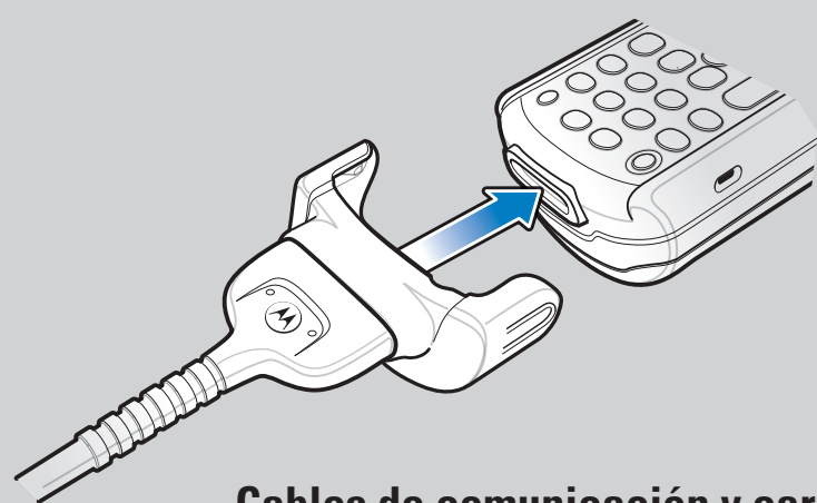
Cables de comunicación y carga
